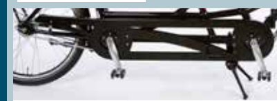
Freewheel crankstel: Het optionele freewheel crankstel geeft de mogelijkheid om onafhankelijk van elkaar te trappen.
