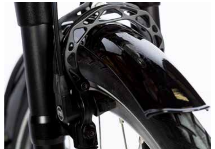
De hydraulische velgremmen van Magura vergen iets meer onderhoud dan de rollerbrakes maar hebben een ongekende remkracht.
