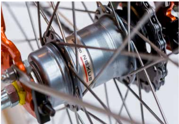
De 3v naaf van Shimano is erg veel gebruikt. Het is de basis waarbij de 1e versnelling gebruikt kan worden om snel weg te fietsen bij de verkeerslichten. Standaard fiets je veel in de 2e versnelling en berg af, wind mee zal de 3e versnelling aan de orde komen. Het is dus iets minder zoeken naar de juiste versnelling. Totaal bereik: 177%
