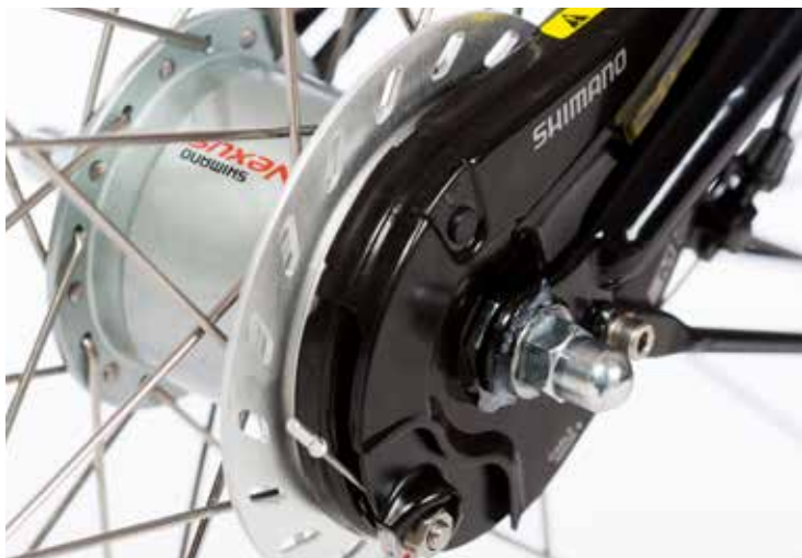
Remmen: Azor kiest voor veel modellen de onderhoudsarme rollerbrake remmen van Shimano. Sommige modellen hebben de BR-C6000, deze hebben een grotere koelschijf en een nog betere remwerking.
