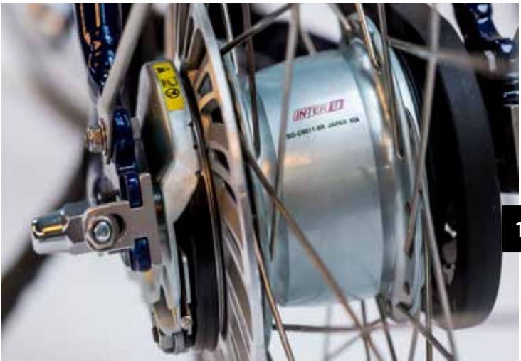
De 8v Premium naaf van Shimano is bijzonder omdat de tandwielen in de naaf van naaldlagers zijn voorzien. Dit maakt de naaf lichtlopende dan de standaard 8v. Azor gebruikt alleen nog Premium 8 naven (m.u.v. R8). Totaal bereik van 307%
