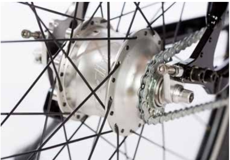
De Rohloff naaf met 14v heeft net zoveel mogelijkheden als een 27v derailleurstelsel. Het grote voordeel van een Rohloff naaf ten opzichte van een derailleurstelsel is, dat de Rohloff naaf weinig onderhoud nodig heeft. 1x per jaar olie verversen volstaat. Totaalbereik 526%
